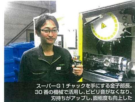
スーパーG1チャックを手にする金子部長。30番の機械で活用し、ビビリ音がなくなり、刃持ちがアップし、面粗度も向上した
